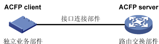
图1-1 ACFP 体系结构示意图
