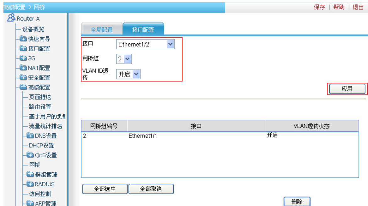
图1-6 配置接口 Ethernet1/2 加入网桥组 2 及 VLAN ID 透传
