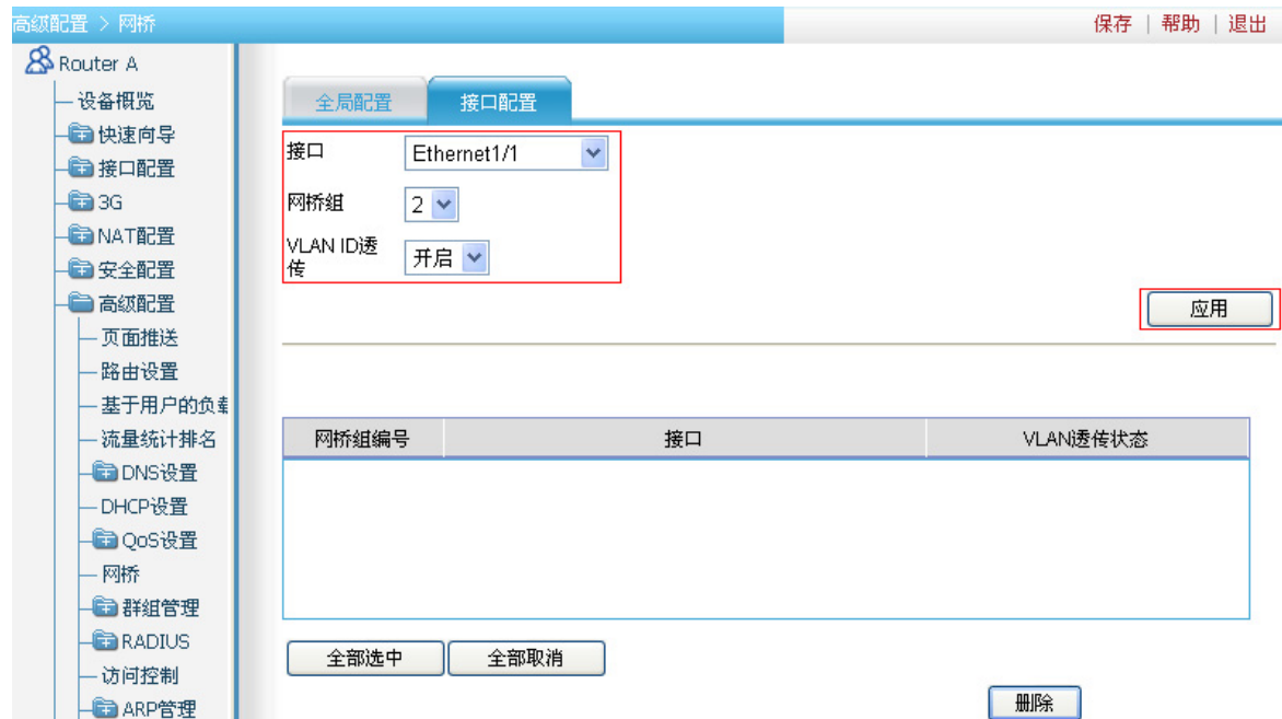
图1-5 配置接口 Ethernet1/1 加入网桥组 2 及 VLAN ID 透传
