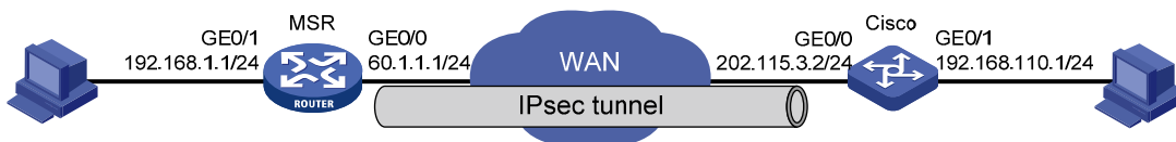
图1 IPsec 虚拟隧道接口与 Cisco 互通配置组网图
