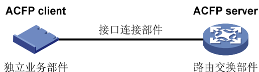
图1-1 ACFP 体系结构示意图
