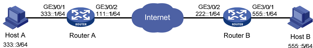
图1-8 保护 IPv6 报文的 IPsec 隧道配置组网图
