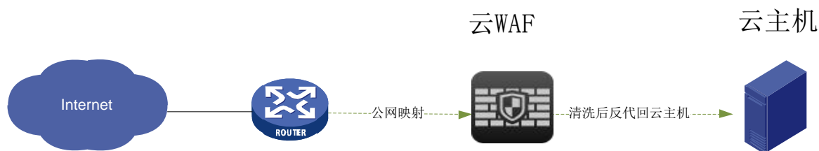
图 3: H3C SecPath W2000-V 系列 虚拟 WEB 应用防火墙反向代理接入示意图
