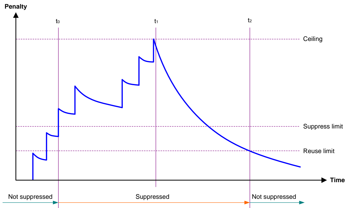
图1-1 dampening 惩罚值变化规律图
